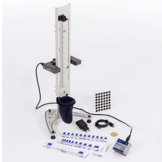
Figura 2 - Aparelho utilizado para delimitar as distancias de percurso da esfera com sensores de infravermelho utilizados na prática experimental
